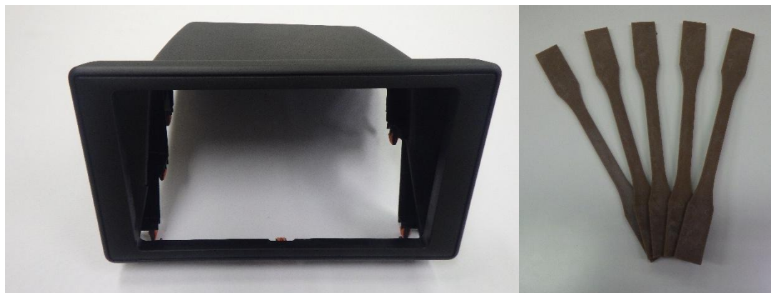
写真1 試験サンプル(例) 自動車部材とダンベル試験片
