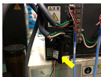
図 2 ヒーターコントローラーに設置した電流センサ(矢印箇所)
