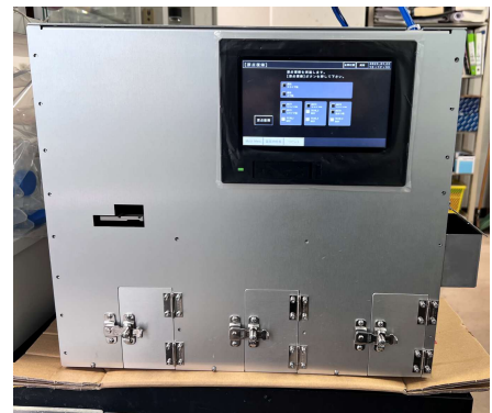
図 1 共同開発した自動 ELISA 測定装置
