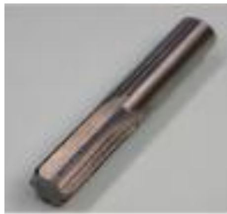
工具試作品 (WC-SiC系硬質セラミックス)
