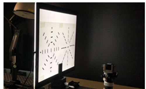
図 3. レンズユニット性能評価システム
