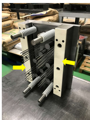
図3 追加した断熱板(矢印箇所)
