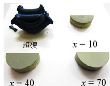
図 1 1000°C 保持後の焼結体の外観
