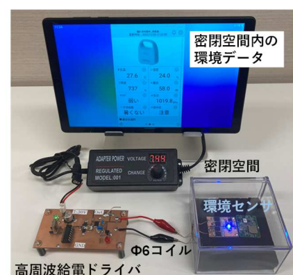
図4 密閉空間内の環境センサへ給電デモ
