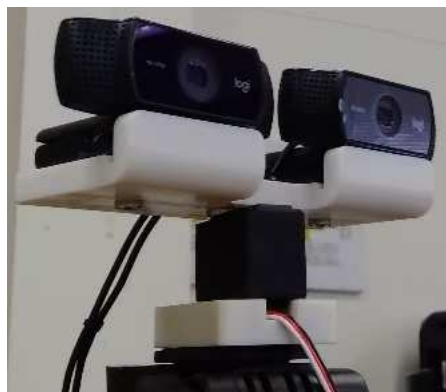
図7 試作したデュアルカメラ機構
