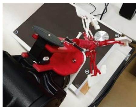
図 8. ロボットハンドを取り付けた 双腕型協働ロボット (俯瞰)
