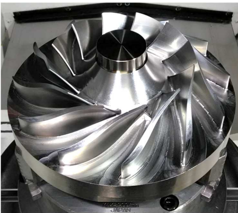
図 3 切削仕上げ加工後のワーク形状
