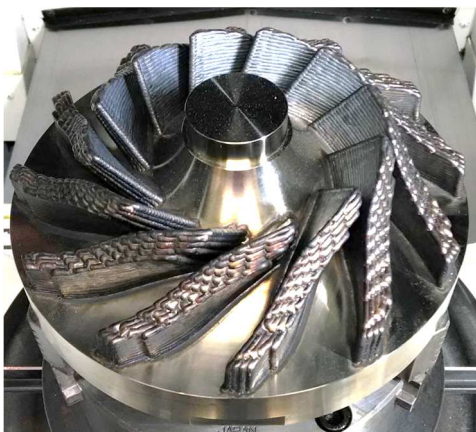
図 2 積層造形後のワーク形状
