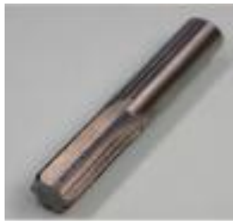
リーマ試作品 (WC-SiC系硬質セラミックス)
