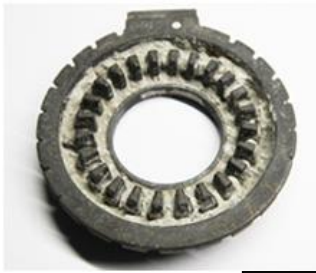
鋳型砂の除去 (粗仕上げ後)
