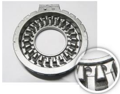
鋳型砂の除去 (粗仕上げ後)
