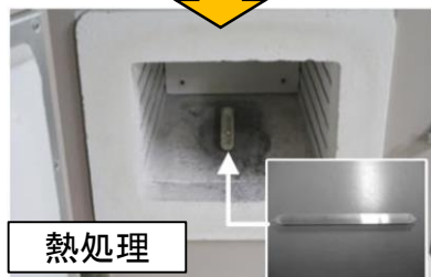
複合材料型はんだ試験片の作製プロセス
