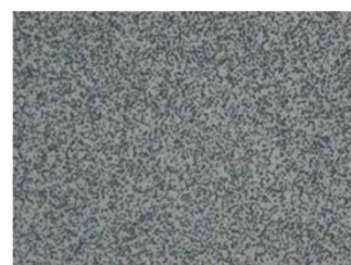
シリカ粒子分散液でのスプレー塗布例 溶媒:水、分散剤、他 シリカ粒子:φ500 nm、基板材質:ガラス
