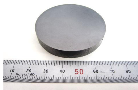
図 1. TiC-50 mol%SiC セラミックス (直径 50 mm、高さ 10 mm、 1800\text{ }^\circ\text{C} )
