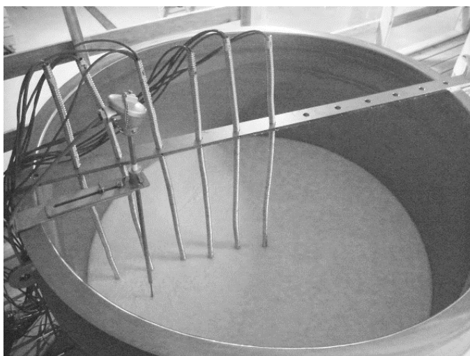
図3 酒母タンク内に設置されたセンサー
