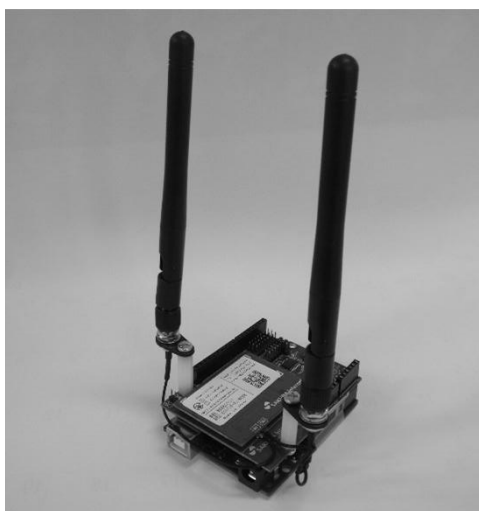
図2 Arduino UNO Rev3 と(LTE)SCM-LTE-01
