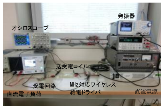
図 1. MHz 対応ワイヤレス給電測定評価システム
