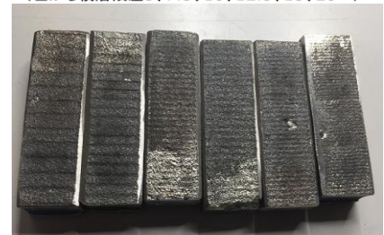
図3 鋳造後の積層段差(塗型なし) (左から積層段差5、7.5、10、12.5、15、20°)
