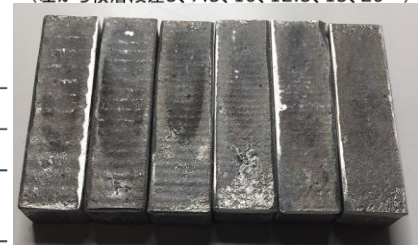
図4 鋳造後の積層段差(塗型あり) (左から積層段差5、7.5、10、12.5、15、20°)
