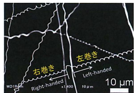
図1 メタルナノコイルの電子顕微鏡写真.
