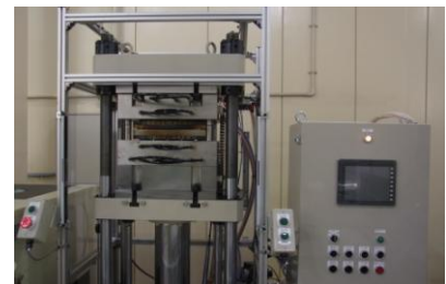
図 1. 複合材料圧縮成形装置
