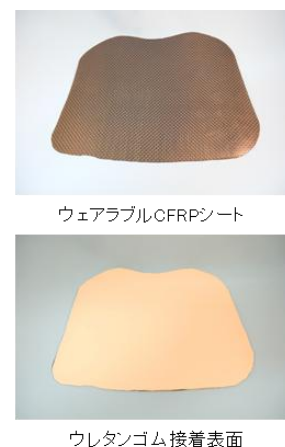
図3 アシストスーツ用固定具モデル
