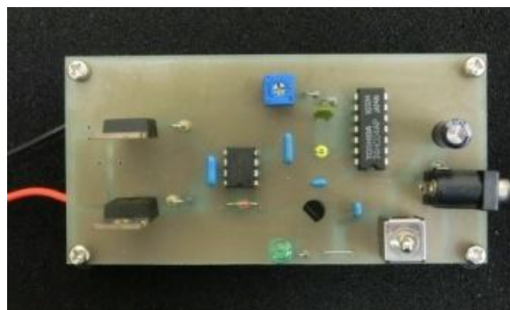
図 2 ワイヤレス給電モジュール
