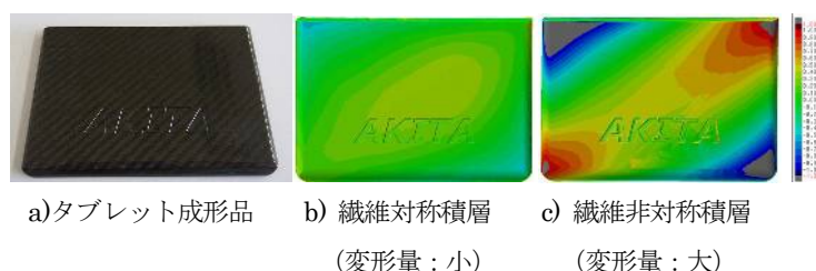
図2 タブレットケース (CFRTP(PA6)/4ply)
