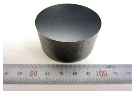
図 1 WC-20 vol%SiC セラミックス (直径 50 mm)
