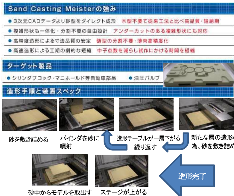
図2 3D 鋳型積層造形装置の特徴と鋳型の造形方法
