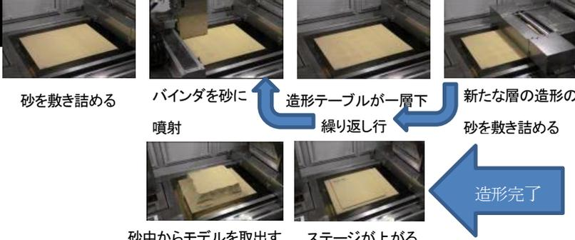
砂を敷き詰める      バインダを砂に噴射      造形テーブルが一層下繰り返し行      新たな層の造形の為、砂を敷き詰める
