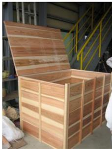
図3 試作した発酵槽
