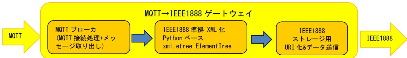
図1. MQTT-IEEE1888 ゲートウェイ
