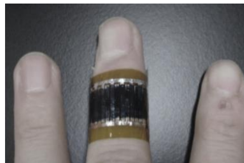
指に巻き付ける事も可能 厚さ0.1 mmで、重さも0.1g以下と軽量
