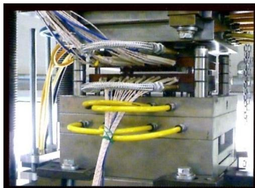
金型 加熱ヒータ・冷却回路
