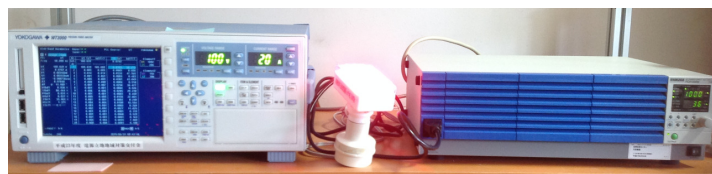
LED照明の電流高調波測定の様子
