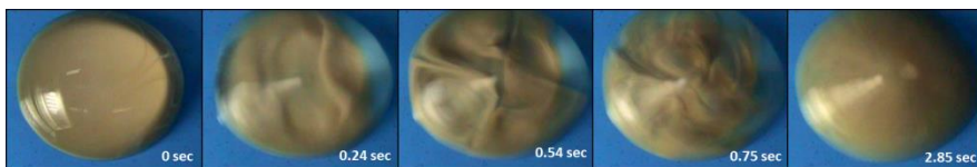
図1.高電圧場印加時の液滴内部の攪拌の様子
